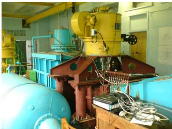
Рис. 5 – Модельный блок, установленный на энергокавитационном стенде ЭКС-15
