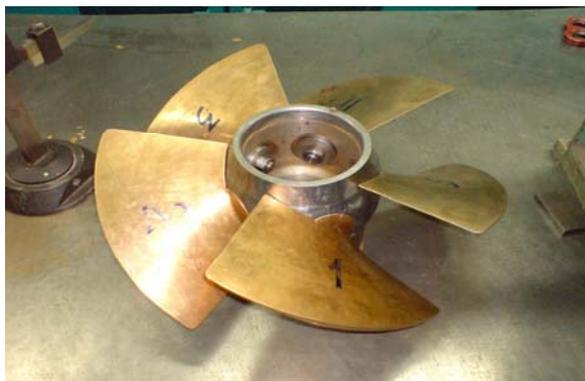
Рис. 4 – Общий вид модели рабочего колеса
